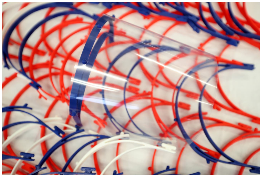
Mittels 3-D-Drucker hergestellte Gesicht-Schutzschilde am Universitätsspital Essen.
